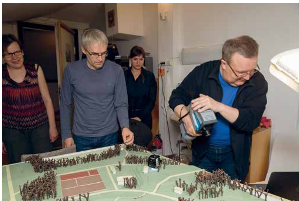
Kääriku spordibaasi maketi värviuringud Misc-MP2 (Zarbecco) digitaalmikroskoobi ja 4300 käsitsevi hoitava FTIR-spektromeetriga (Agilent Technologies). Pildil Ülle Vahar, Jaan Lehtaru (RA), Triinu Siilbek ja Kurmo Konsa (TKK).
