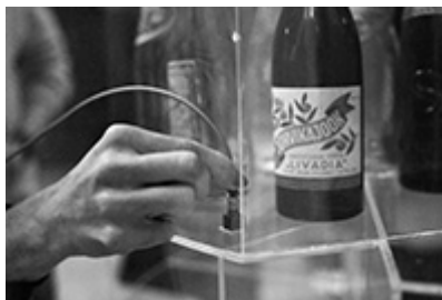
Foto 2. Kiirendusanduri kinnitamine pleksiklaasist vitriini riiulile püsinäituse „Kohtumised“ teemanäitusel „Moodsad ajad“.
