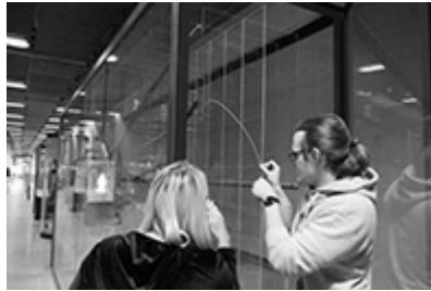
Foto 3. Kiirendusanduri kinnitamine püsinäituse relvavitriini pleksiklaasist sõrestikule.
